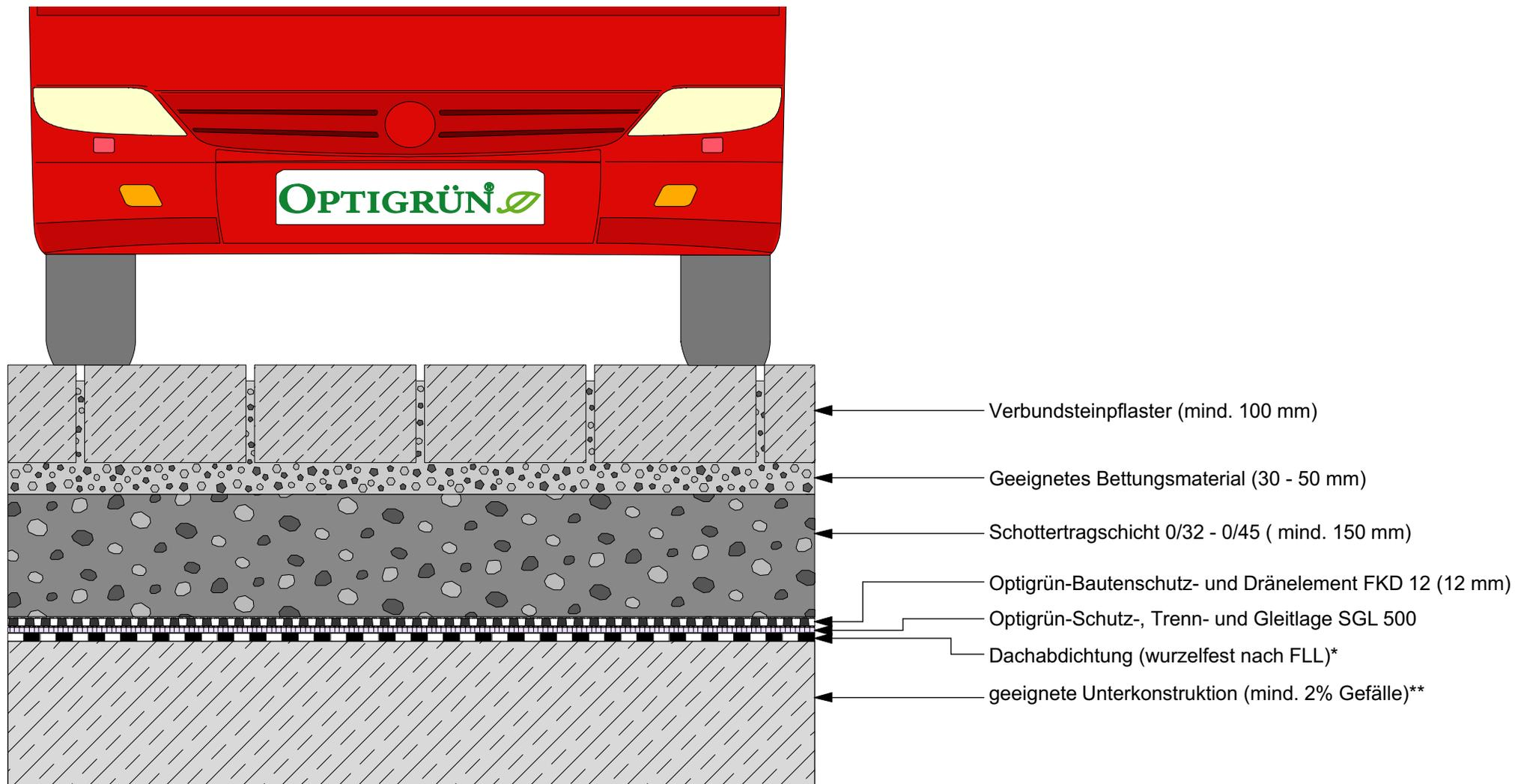
\* Gewerk Dachabdichtung    \*\* Gewerk Hochbau    \*\*\* Für gelegentliche LKW-Befahrung ca. 1 x pro Tag bis 30 t Fahrzeuggewicht
