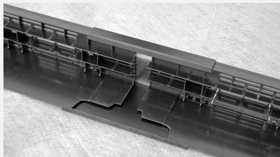
Zuschnitte mittig zwischen zwei Ecken vornehmen und Elemente mittels eines Verbinders aneinanderfügen. Zuschnitt und Bearbeitung der Kiesleisten mit Winkelschleifer oder Handsäge vornehmen.
