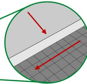
Die Matten dicht gestoßen ausrollen. Die Verlegung quer zu der Verlegerichtung der Dränelemente vornehmen.
