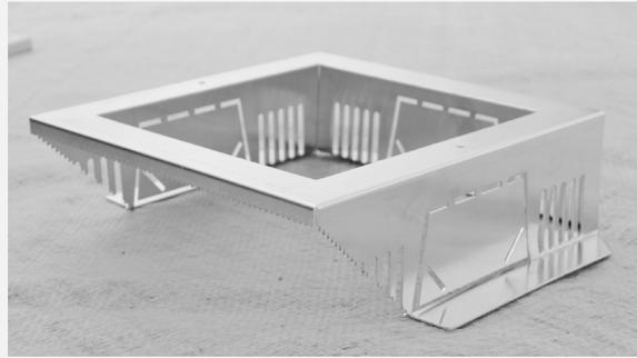
Bei Bedarf Ausstanzungen für Wasserleitkanäle aufbiegen. Bei überdichteten Dämmkeilen das Dämmkeilprofil aus dem Kontrollschacht ausbrechen bzw. ausschneiden. Bearbeitung des Kontrollschachtes mit einer Bleischere vornehmen.
