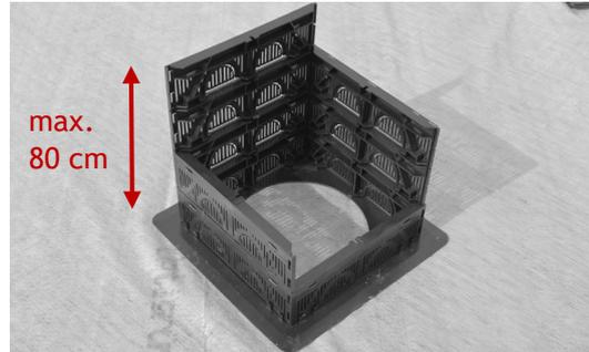
Wechselseitig unterschiedlich hohe Komponenten auf die Grundplatte aufstecken, um größtmögliche Stabilität des Verbundes zu schaffen. Seitenteil mit vormontiertem Verschlussmechanismus in der letzten Reihe einsetzen. Die maximale Höhe des Schachtes beträgt 80 cm.
