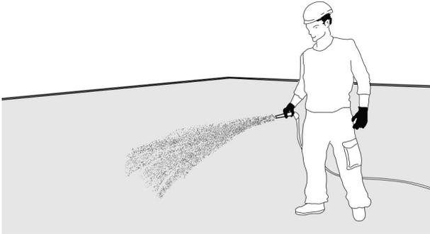
Während der Einwurzelungsphase (ca. 4-6 Wochen) die Austrocknung des Begrünungsaufbaus vermeiden. Bei Bedarf zusätzlich temporär bewässern. Eine Fertigstellungspflege gemäß FLL-Dachbegrünungsrichtlinien ist zur Erreichung des abnahmefähigen Zustandes in der Regel notwendig.
