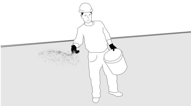
Sprossen gleichmäßig auf der Dachfläche verteilen.
