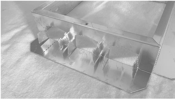
Bei Bedarf Ausstanzungen für Wasserleitkanäle WKK und/oder für Wasserleitkanäle WKA aufbiegen.
