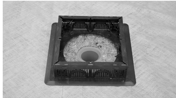
Kontrollschächte mittig über dem Dachablauf platzieren. Randkontrollschächte möglichst dicht an das aufgehende Bauteil anlegen. Ggfs. Wasserleitprofile anschließen
