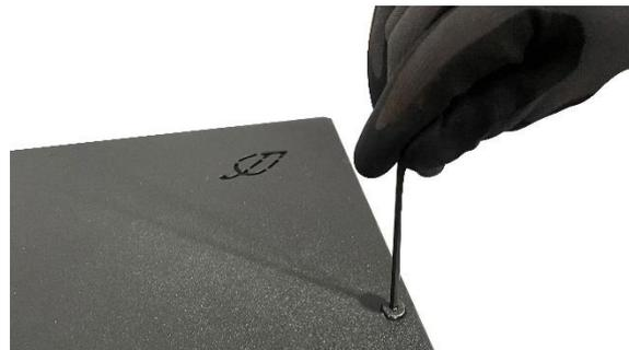
Abbildung 10: Deckel befestigen
